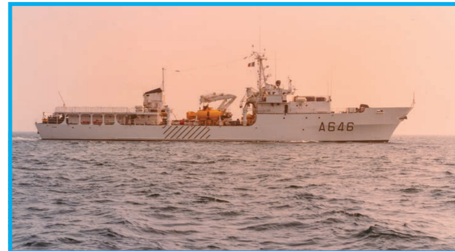
BISM Triton : déplacement : 1500 tonnes - vitesse : 13 nœuds - longueur : 75 mètres.
