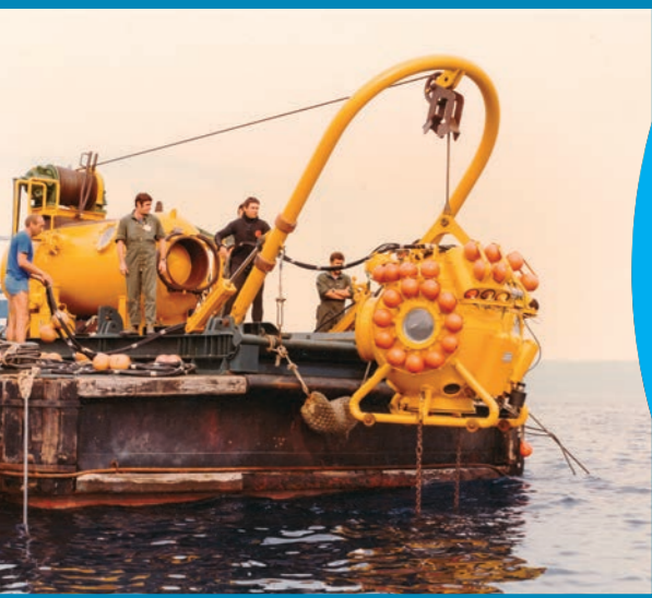
Système unité légère d'intervention sous-marine (ULISM) - 2 plongeurs en incursion jusqu'à 150 m. Monté sur la barge support nautique Nautille
