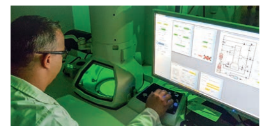
Dénombrement et caractérisation des fibres dans un échantillon (ici une fibre de verre)
