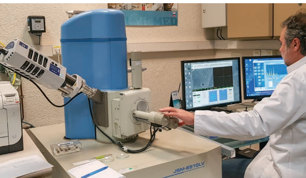
Microscope électronique à balayage (grossissement x 40 000) permettant l'identification des fibres d'amiante dans des matériaux
