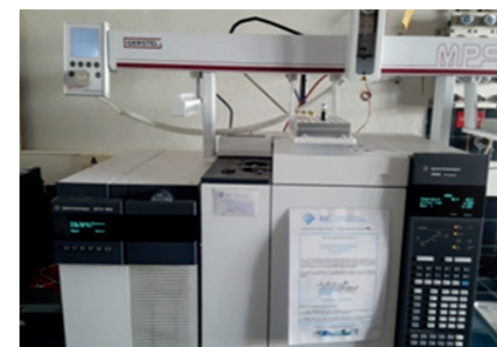
Chromatographe en phase gazeuse couplée à un spectromètre de masse permettant la détection de composés organiques à l'état de traces
