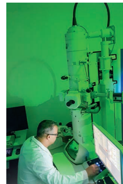
Microscope électronique à transmission permettant des grossissements jusqu'à x 600 000
