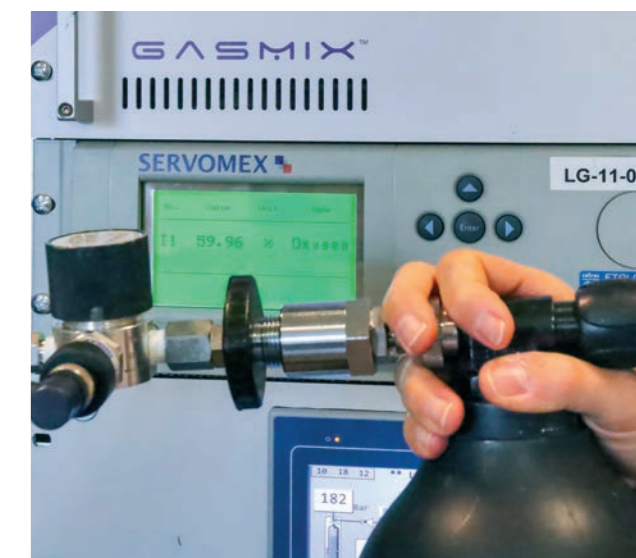
Gaz étalons permettant l'étalonnage des analyseurs
