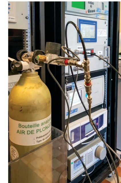
Baie de l'Unité Gaz permettant les analyses en ligne
