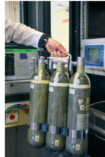
Analyse du contenant d'un ARI, bouteilles en composite, gonflées à 300 bars et utilisées par les services de sécurité
