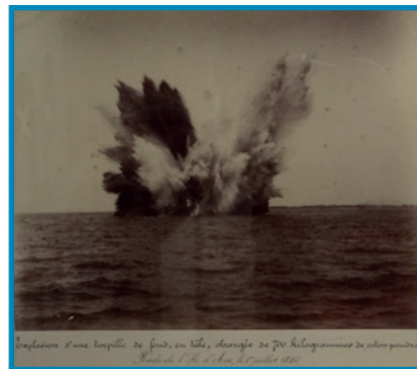
Il n'est pas certain que l'école s'intéressa aussi aux mines de fond mais cette photo du Musée de la Marine de Rochefort montre l'explosion d'une mine de fond, charge de 700 kg de coton-poudre, en rade de l'île d'Aix, en 1886. C'était forcément un essai.
